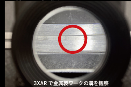
3XAR で金属製ワークの溝を観察
